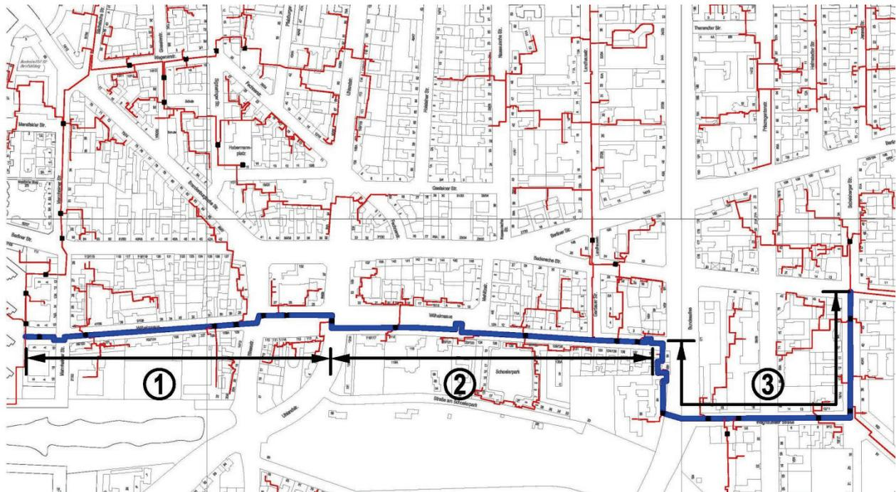
Abbildung 6: Beispiel zur Potentialermittlung für geeignete Trassenabschnitte für Rücklaufanschlüsse
